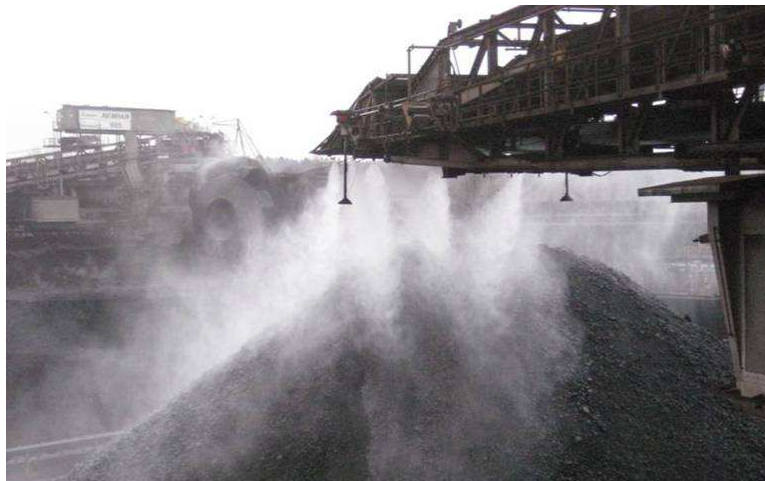
Abb. 5.3/11: Hochdruckbedüsung an Bandschleifenwagen
