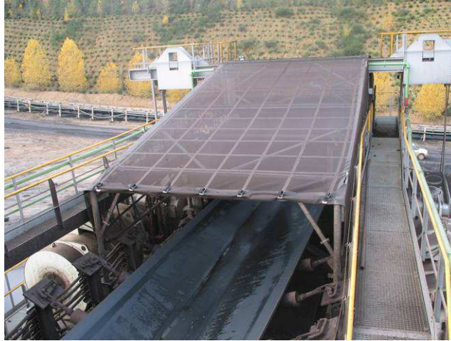
Abb. 5.3/9: Abdeckungen in den Übergabebereichen des Kohleförderweges
