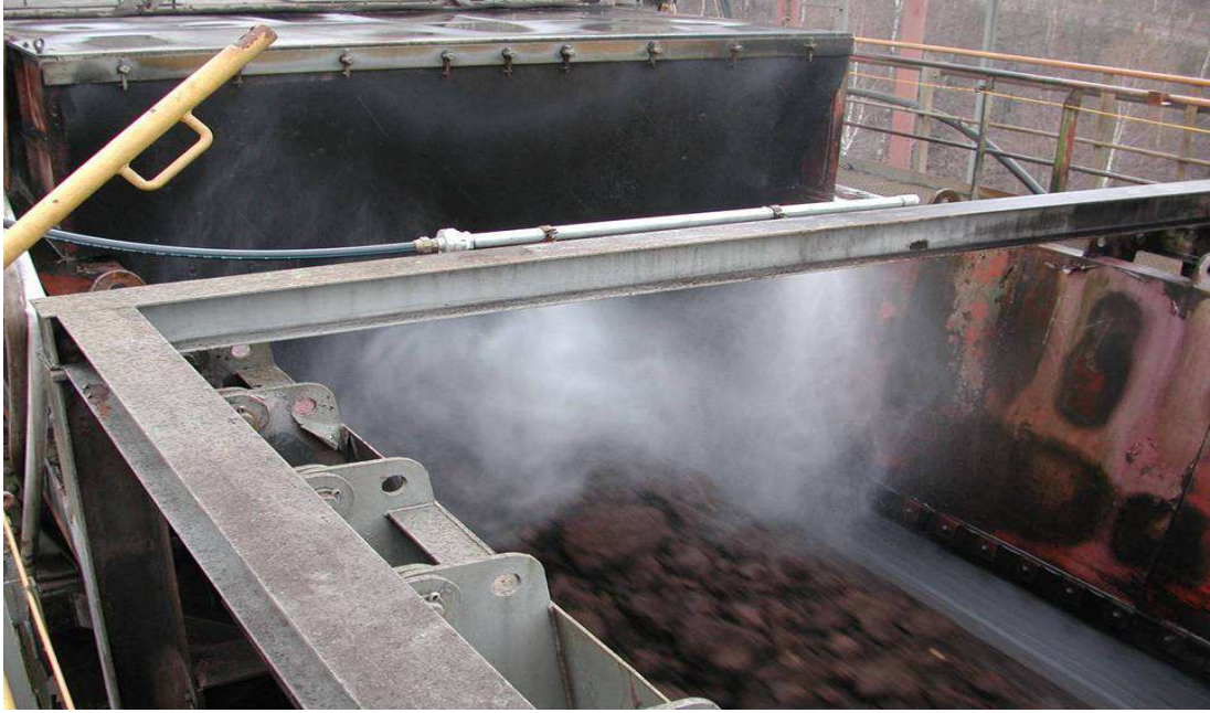
Abb. 5.3/3: Optimierung der Beregnerdüsen im Bereich der Kohleförderwege
