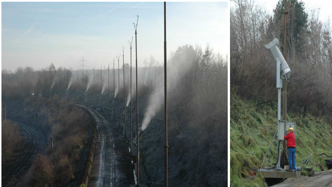
Abb. 5.3/2: Feinstnebelkanonen im Bereich des Kohlebunkers
